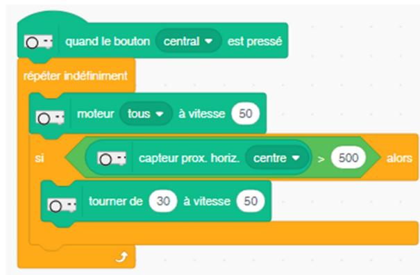
Tester le programme : appuyer sur le bouton central de Thymio et vérifier que Thymio avance tout droit quand il n'y a pas d'obstacle et tourne vers la droite quand il y a un obstacle. Ajuster les valeurs (capteur, angle, vitesses) en fonction du résultat désiré.
