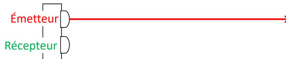
Si il n'y a pas d'obstacle, aucune lumière ne revient vers le récepteur.
